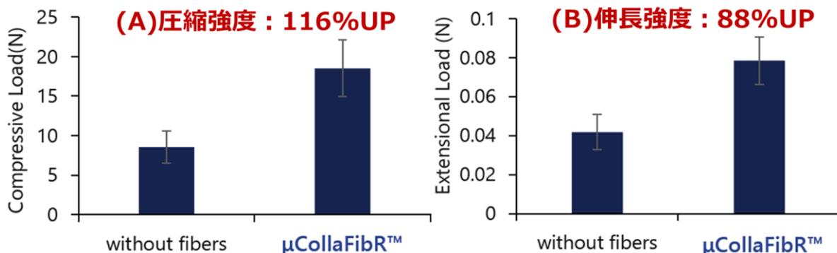
(A) 1.25mg/mLの $\mu$ CollaFibR™の添加の有無による5%wt GelMA構築物の圧縮強度試験の結果
