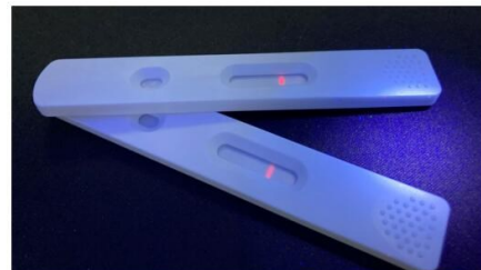
量子ドット球状粒子のイムノクロマトグラフィーへの応用
