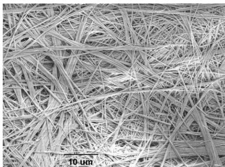
▲ Potassium Trimolybdate (K<sub>2</sub>Mo<sub>3</sub>O<sub>10</sub>) Nanowires, SEM画像
