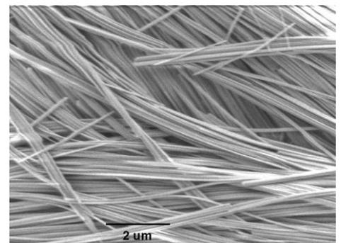
▲ Sodium Ammonium Trimolybdate (NaNH<sub>4</sub>Mo<sub>3</sub>O<sub>10</sub>) Nanowires, SEM画像
