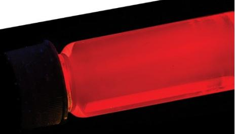
マイクロLED、Mini LED、OLED向け色変換用の量子ドットインクです。広色域かつエネルギー効率の高いディスプレイの作製に最適なソリューションです。
