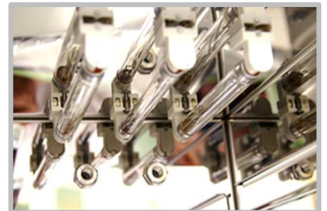
UV253V8には直管型UVランプが 3本搭載されています。
