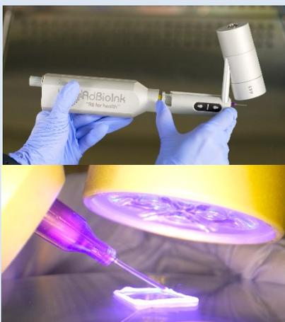
従来の3Dバイオプリンターは、高価であり、体外で造形物を作製するために使用されました。しかし、設計されたモデルをプリントするだけなので、*in vivo*への移植などで求められる曲面上での希望の形状の実現が困難でした。本製品はハンディ型であるため、低価格で優れた携帯性と操作性があります。損傷した組織への直接のプリンティングや、曲面上での作業も可能です。
